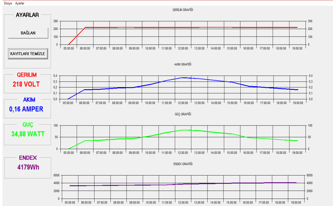
Şekil 9. Güneş takip sisteminin bağlı olmadığı panel grafiği
