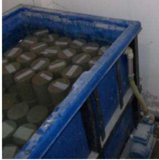
Şekil 1. Standart kür ortamında tutulmuş silindirik beton numuneleri.
