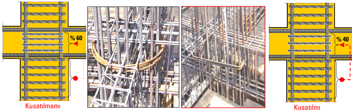
Şekil 8: Kolon-kiriş birleşim bölgesi kesme donatısı miktarının etkisi
