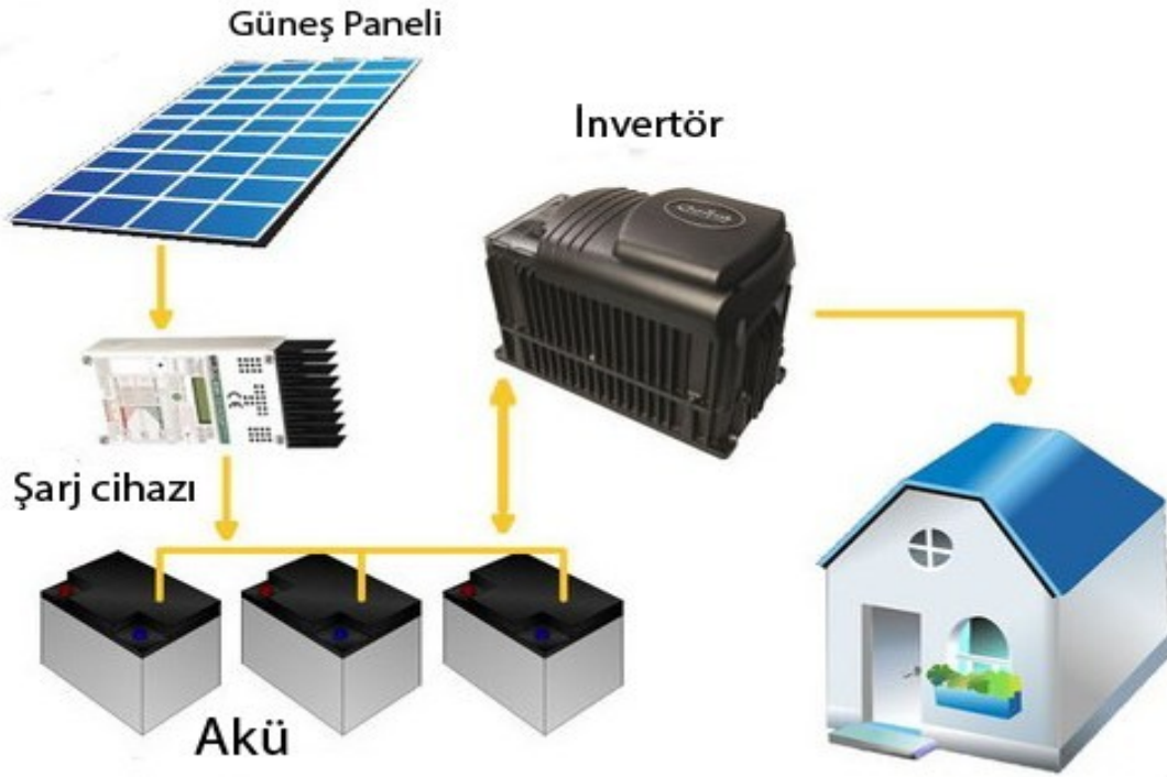
Şekil 2.3. Güneş enerjisinden elektrik elde etme aşaması
