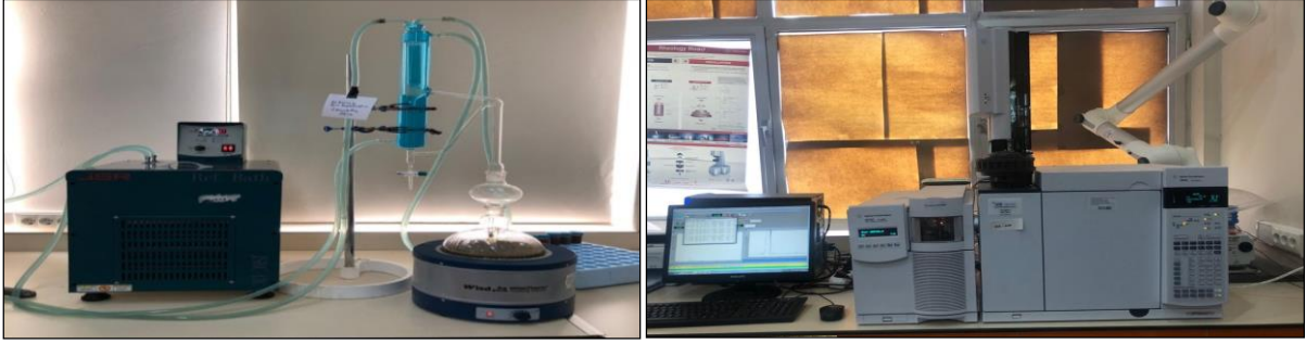
Şekil 2. Çalışmada kullanılan modifiye soğutuculu Clevenger ve Agilent-7890 cihazı
